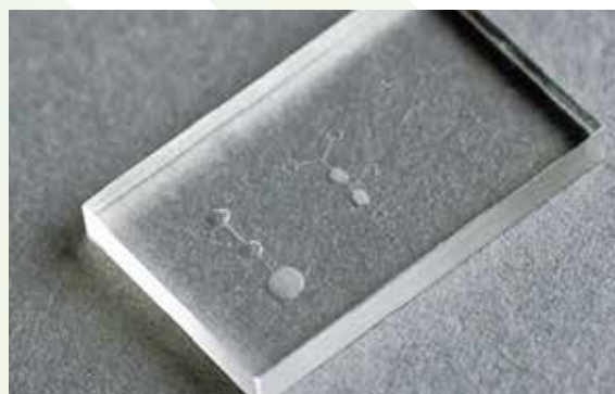
(写真⑤)アクリル板へのマイクロ流路加工
